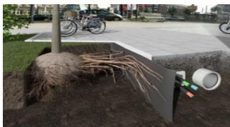
รูปที่ 4.4.4-16 ตัวอย่างรายละเอียดแผ่นป้องกันราก (Root Barrier)
