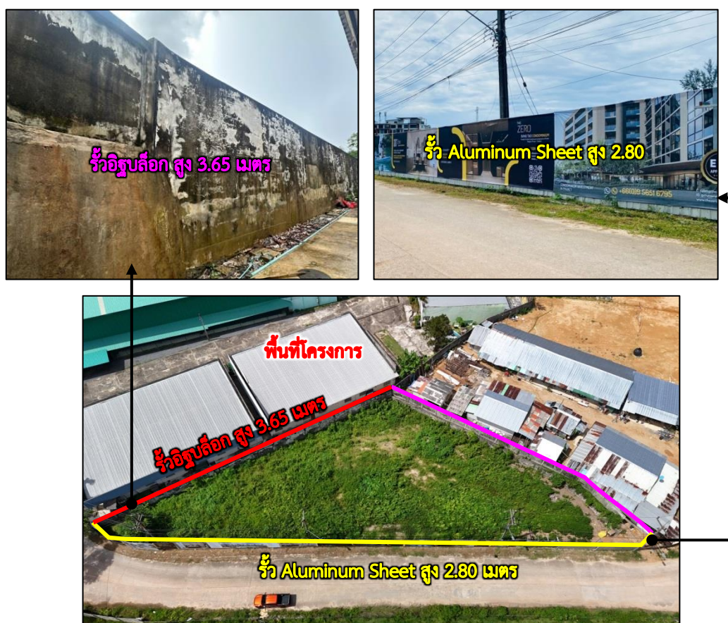
รูปที่ 4.4.4-1 รั้วชั่วคราวและรั้วทูปล็อก รอบแนวเขตพื้นที่ก่อสร้าง
